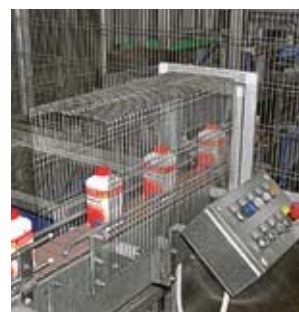
4 Feste Schutzeinrichtungen nicht entfernen.
