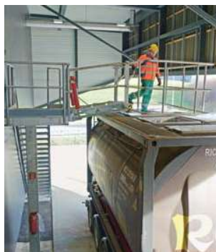
Regel 5 Gegen Absturz sichern.
