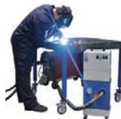
3 Brenner mit integrierter Absaugung
