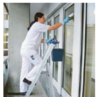
4 Richtig eingesetzte Bockleiter mit Sicherheitsbrücke und Haltevorrichtung
