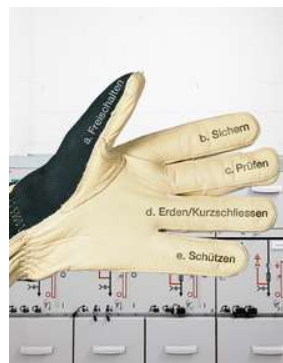
+ 5 Sicherheitsregeln für spannungsfreies Arbeiten.
